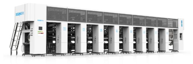
由于凹版印刷机的油墨层比胶版印刷的油墨层厚,因此在印刷一种颜色时,必须使用干燥系统来快速挥发和干燥印刷品上的油墨溶剂,以便将油墨固定在印刷机上。基质。每种颜色都必须干燥,并确保墨水的干燥速度与打印速度匹配。凹版印刷机的干燥方法通常是热风干燥。该干燥装置由加热设备,通风设备和排气口组成以形成热空气干燥室,并且通过穿过热空气干燥室来干燥打印的片材。调节风量后,以控制干燥速度。选择这种镗孔设备将减少打印纸的变形,并有助于确保打印质量。印刷纸用热空气干燥后,通常应通过冷却辊进行冷却。凹版印刷机目前,凹版印刷机的干燥热源主要有以下几种选择:通过电热管的干燥过程;通过高温蒸汽进行干燥过程;通过燃煤锅炉的干燥过程;柴油焚烧的干燥过程。
