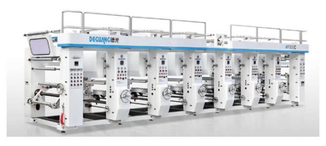
印刷机齿轮箱发热:需要及时检查齿轮箱内润滑油情况,润滑油能够有效保持齿轮箱内传动部件的润滑,冷却部件失效;齿轮箱发热并伴随着齿轮箱噪声增大时,可能是齿轮箱内部有传动部件磨损或损坏,需及时停机检查;查看是否有油墨或溶剂从齿轮箱锥顶杆流进齿轮箱内,导致轴承损坏或其他传动件损坏。印刷机版轴横向套色精度差:动力侧锥堵结构为气缸锥顶形式,手动阀是否旋转在气缸退出(进气)状态下。锥堵是否与版筒贴合良好,是否出现打滑间隙,查看锥堵与版筒贴合处,是否出现划痕或发热;版轴横向自动的永磁低速电机是否工作正常,是否有异常现象;可通过手动套色来检验动作,同时也可通过手动套色调准套色后调整回自动,观察套色的变化情况;印版或装版精度原因浙江德光机械有限公司致力于提供塑料袋凹版印刷机,有需要可以联系我司。电脑高速凹版印刷机哪个好
